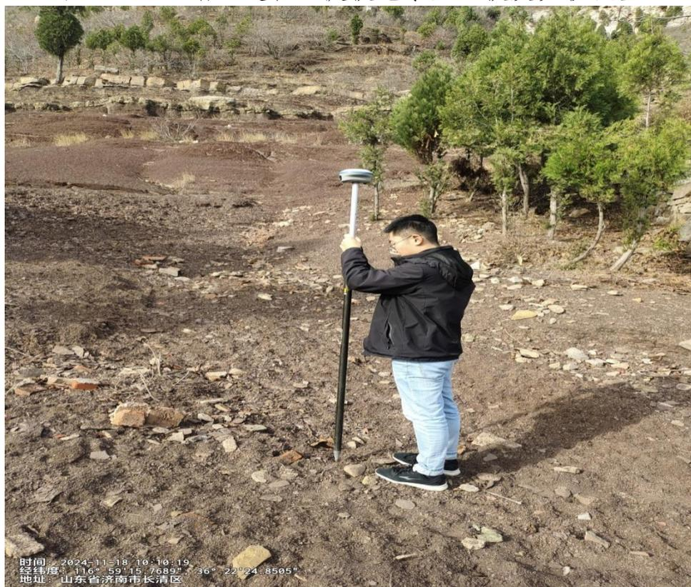
图 4-39 长清区灵岩山陡坡地禁垦区坡度复核测量
