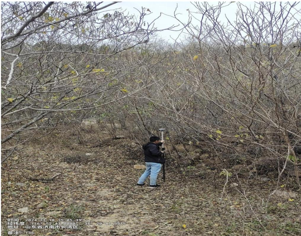
图 4-41 长清区西山寨山陡坡地禁垦区坡度复核测量
