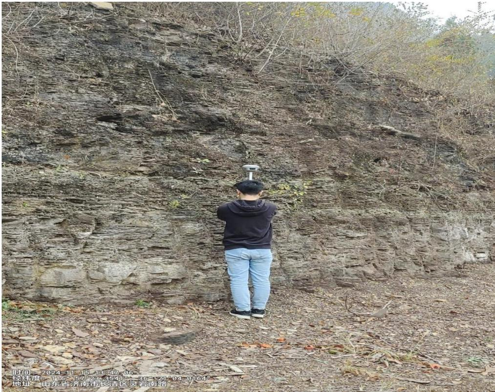
图 4-40 长清区鸡冠山陡坡地禁垦区坡度复核测量
