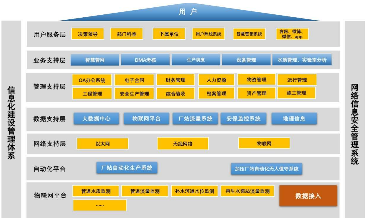
图 8-1 再生水信息化应用系统构架图
